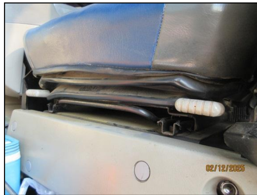
รูปที่ 48 วัสดุอุปกรณ์ป้องกันความสั่นสะเทือนรองใต้ที่นั่งของเครื่องจักร
